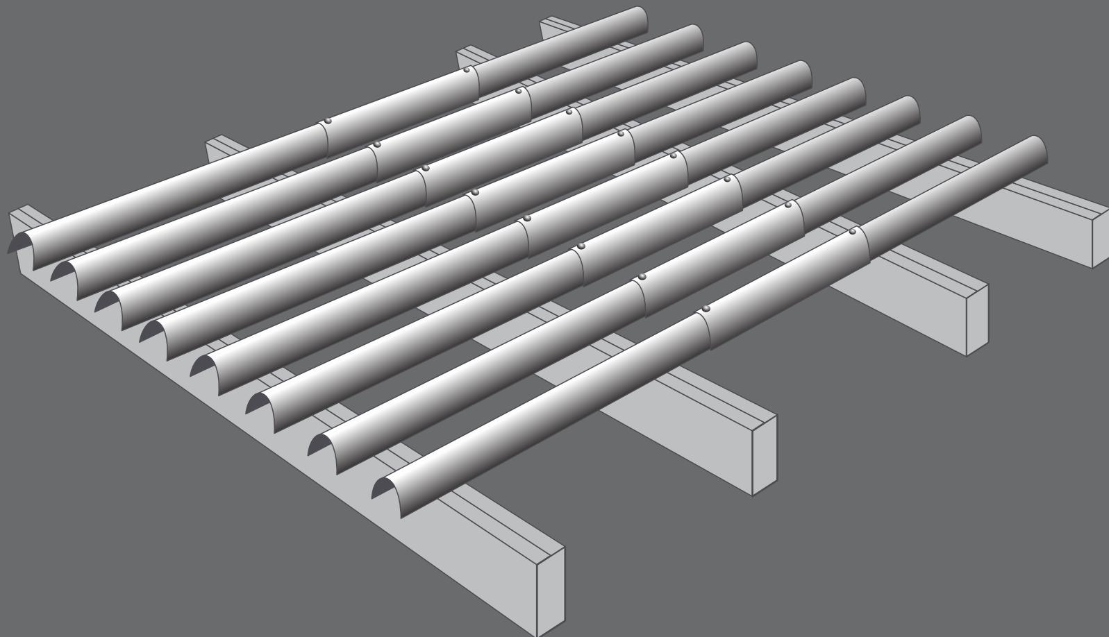
O mata-burro da Takono é composto de dois módulos de dimensões idênticas, que são unidos posteriormente por meio de distanciadores, que conectam um módulo a outro por meio de parafusos.
