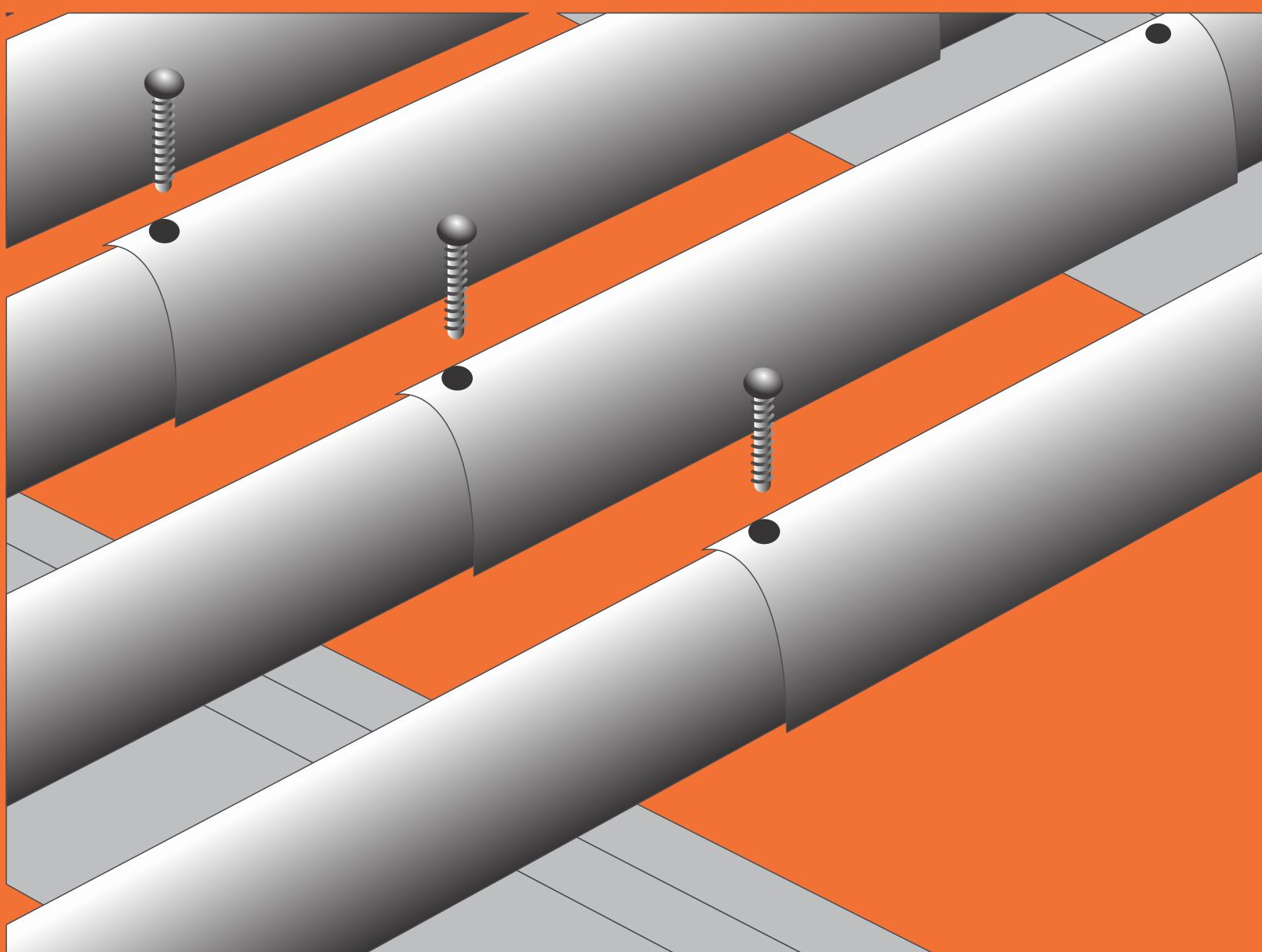
Obs: A fim de se obter uma maior capacidade de carga do mata-burro, pode-se preencher o interior das peças longitudinais dos módulos 01 e 02 com concreto.
